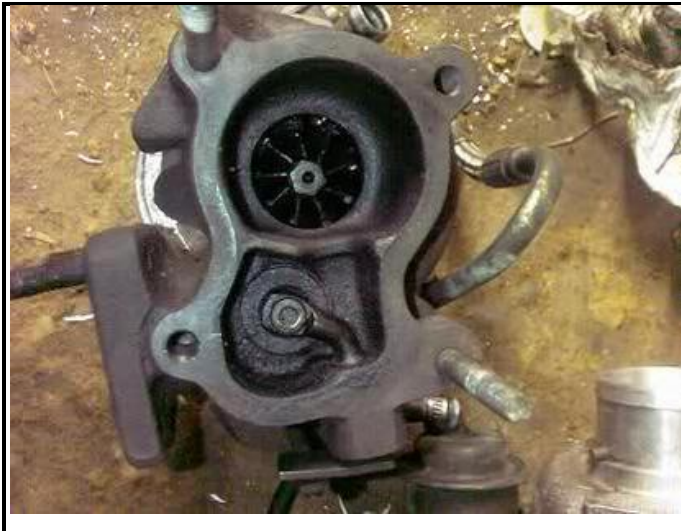
D1) Foto della Turbina vista dal lato Scarico (corpo caldo)
